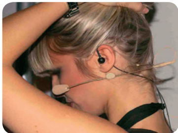
Megfelelően rögzített fülmonitor és headset.
