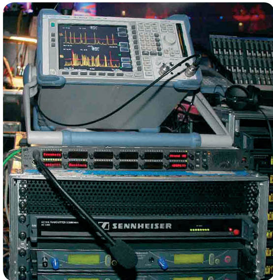
A spektrumelemző azonnal figyelmeztetett, ha új vezeték nélküli frekvenciák jelentek meg.
