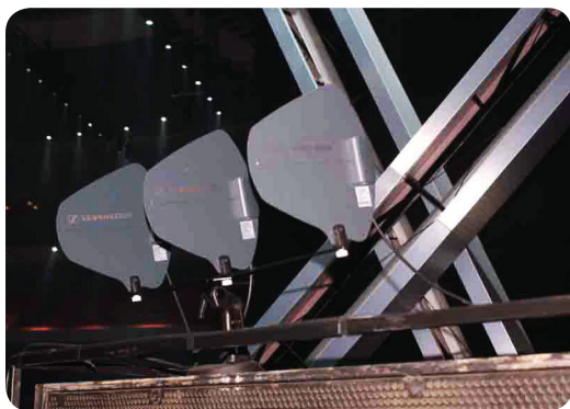
Az összes LogPeriodic vevőantenna megközelítőleg azonos iránykarakterisztikával rendelkezett.
