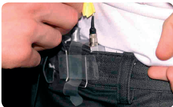
Az adóegységeket ragasztószalaggal szorították le, vagy zsebek segítségével helyezték biztonságba.
