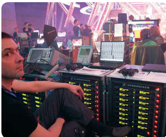
Fedor folyamatosan ellenőrzi a vételt az RF munkaállomáson
