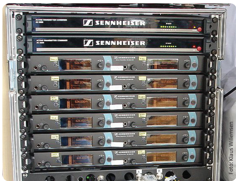
12-csatornás fülmonitor-rendszer az Aida opera "élő show" változatában (Rhine folyó, Bazel, 2010).
